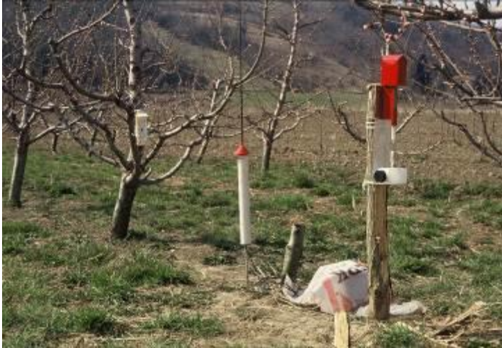
Slika 38: Alarmna naprava domače izdelave - akumulator, mokri kontaktni termometer in oddajnik.
